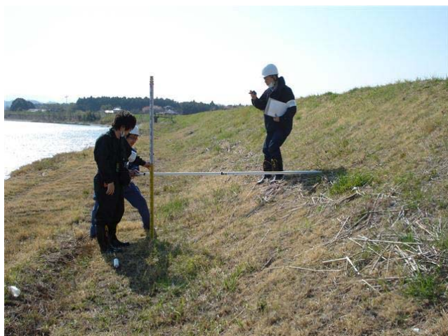
写真 2.3.1-3 河川遡上津波の痕跡
